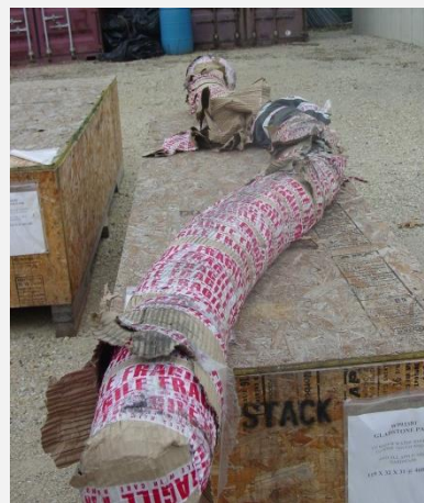
Emballage de composant à destination indiquant un dommage au cours de l'expédition.
